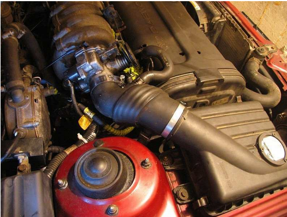
Jedna z możliwości uszczelnienia rury dolotowej powietrza.
