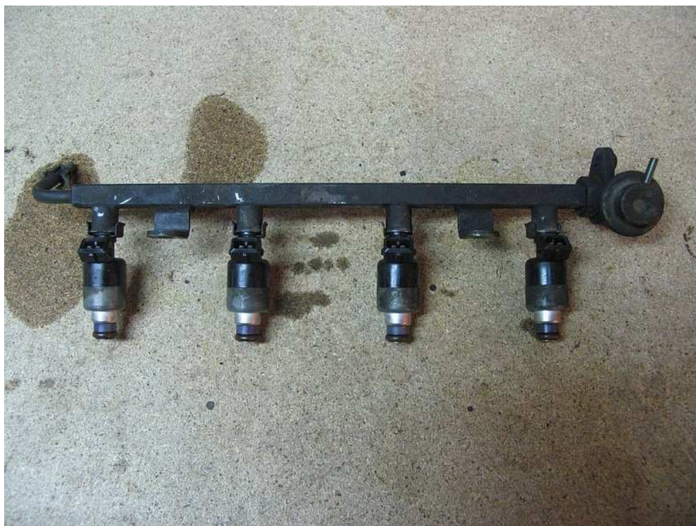
Listwa wtryskiwaczy z wtryskami, w tej pozycji jest zamontowana na silniku.
