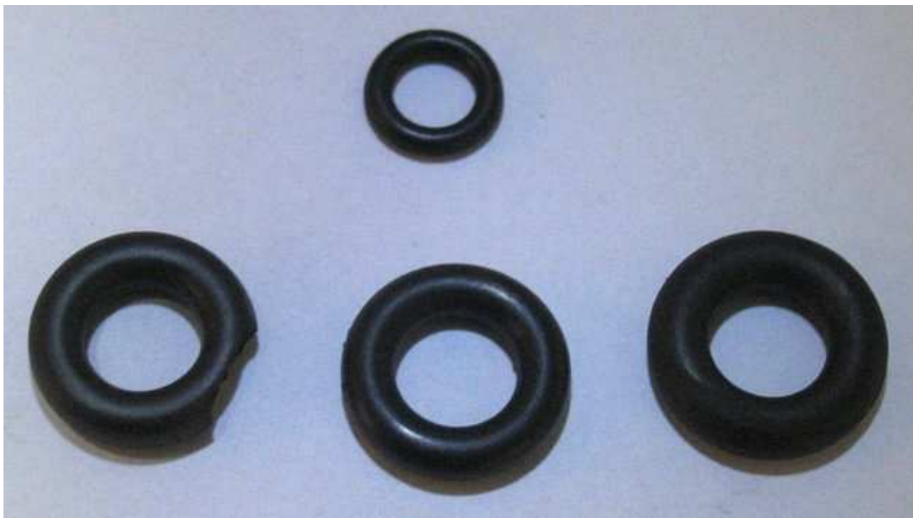
Od lewej oryginalny uszkodzony o-ring, o-ring 8x3,5, o-ring 8x4. U samej góry o-ring 7x2.
