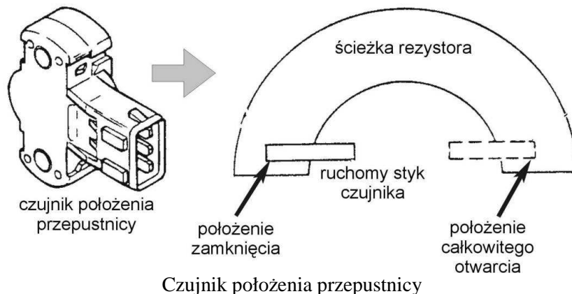
Budowa złącza i schemat elektryczny czujnika położenia przepustnicy
