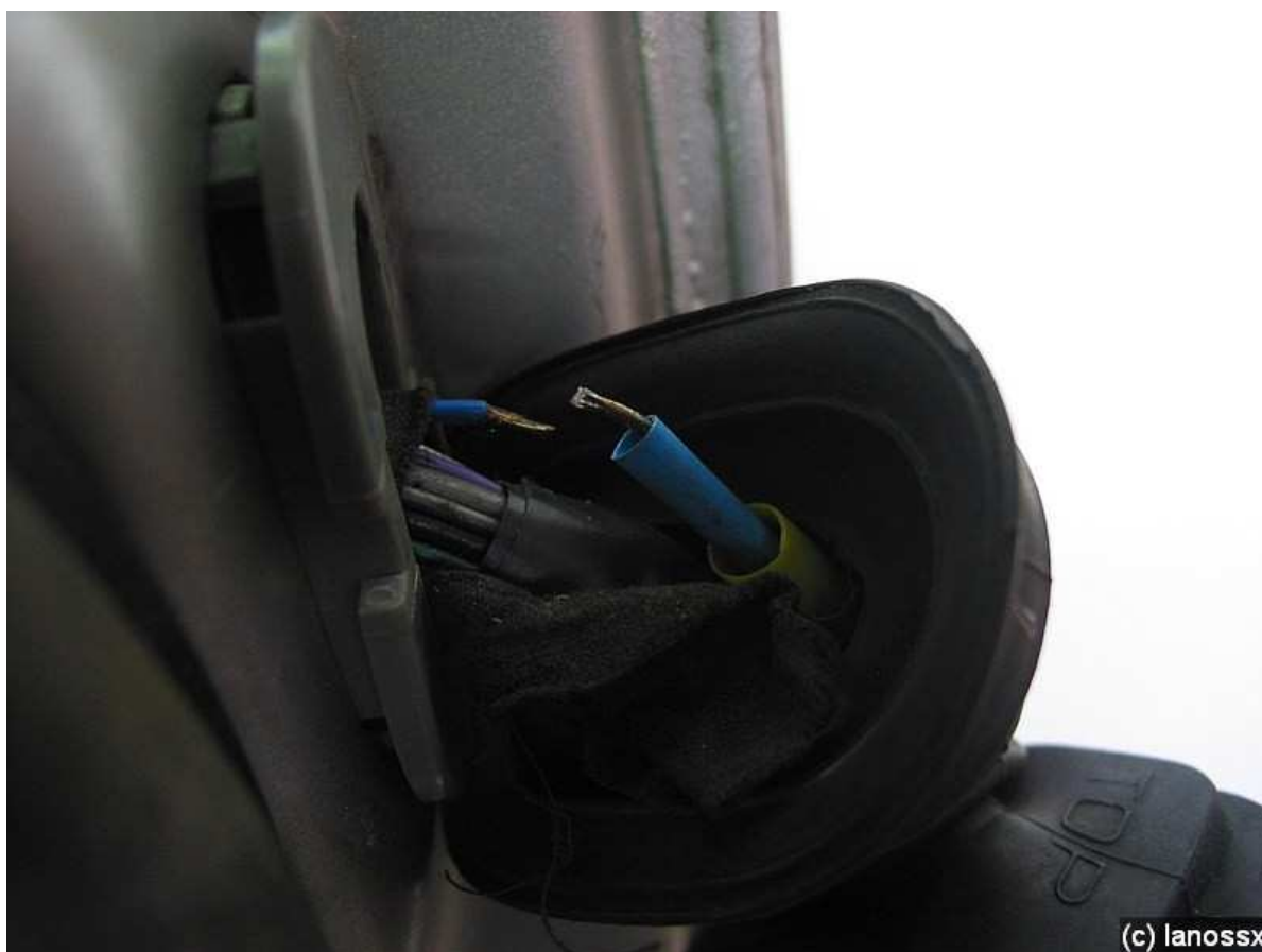
Szybka naprawa. Dolutowanie pół centymetra miedzi.
