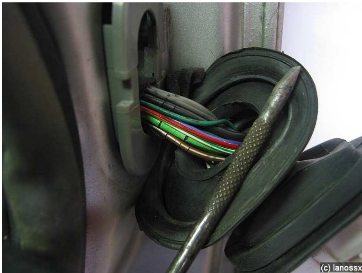
Sfatygowana izolacja przewodów
