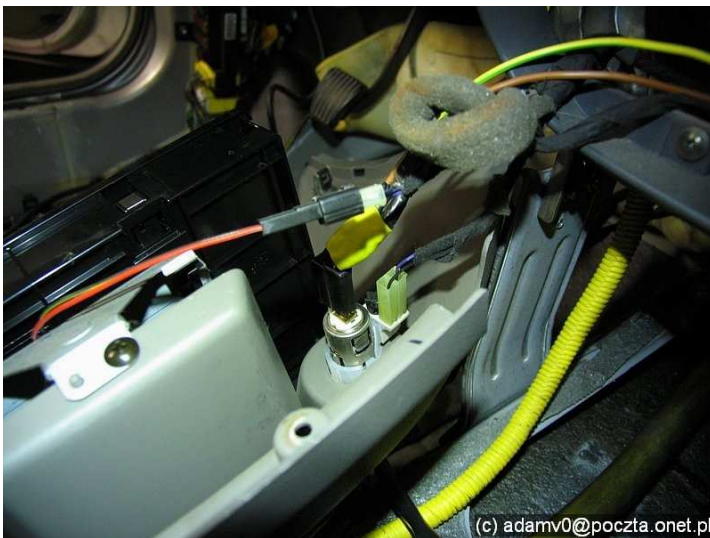
Złącza zasilania zapalniczki i podświetlania popielniczki i zapalniczki
