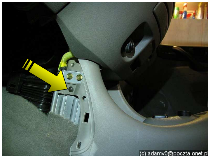
Odkręcamy śruby po obu stronach. Należy zdjąć osłonę lewarka delikatnie pociągając jej spodnią część rękami. Następnie włożyć rękę do środka i wypchnąć panel włączników podgrzewania foteli.
