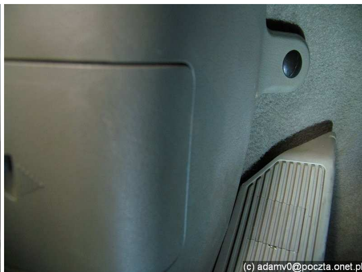
Odkręcamy plastikową nakrętkę i pociągamy część do siebie
