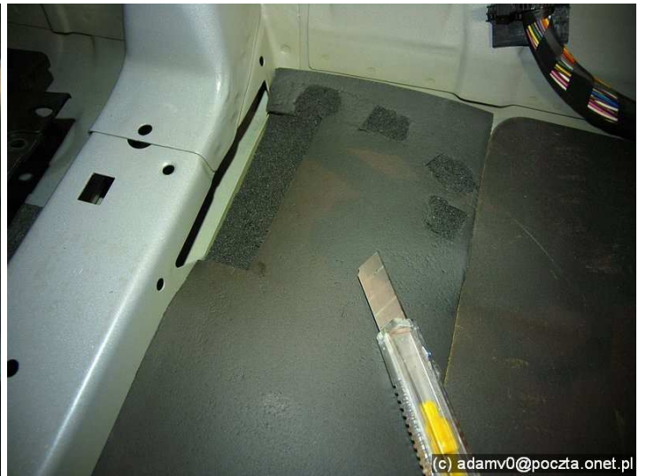
W puste miejsce wkładam matę 1 cm. W pokazanych miejscach wycinam na 0.5 cm, dla lepszego montażu nawiewów (po to aby nie siłować się).
