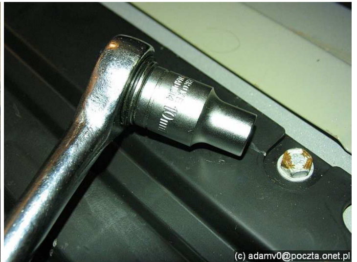
Potrzebny klucz 10 mm, odkręcamy pięć śrub
