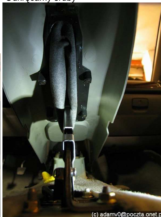
Odkręcamy od spodu mocowanie osłony ręcznego.
