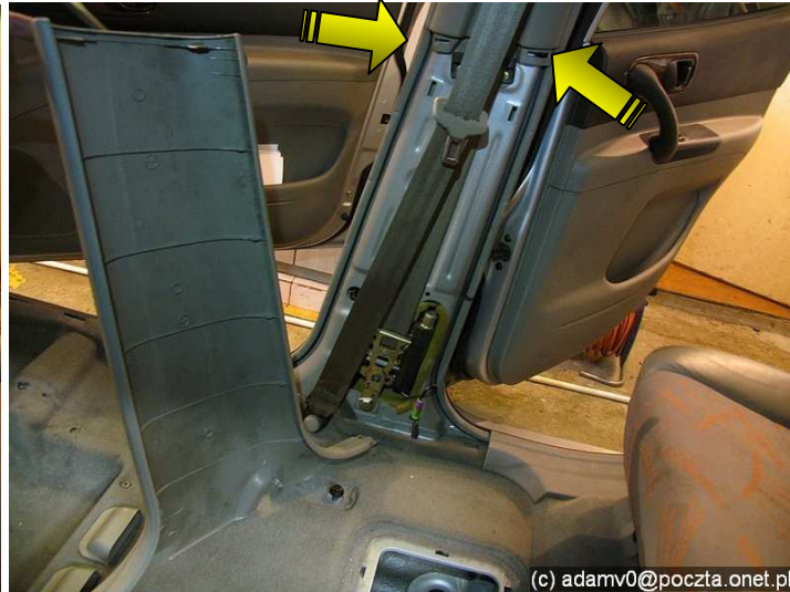
Delikatnie podważamy i pociągamy z lewej i prawej strony, na całej wysokości. Zatrzaski są w górnej części. Poprawie lepiej jest najpierw zdemontować osłonę progów w tylnym rzędzie siedzeń.
