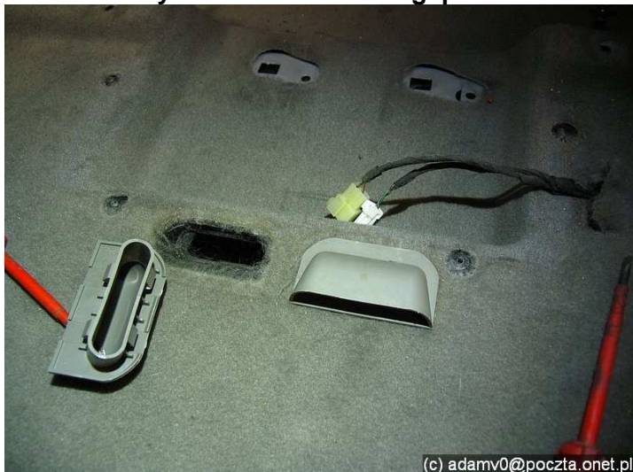
Dobrze podważyć w tylnej części, czyli od strony pasażera
