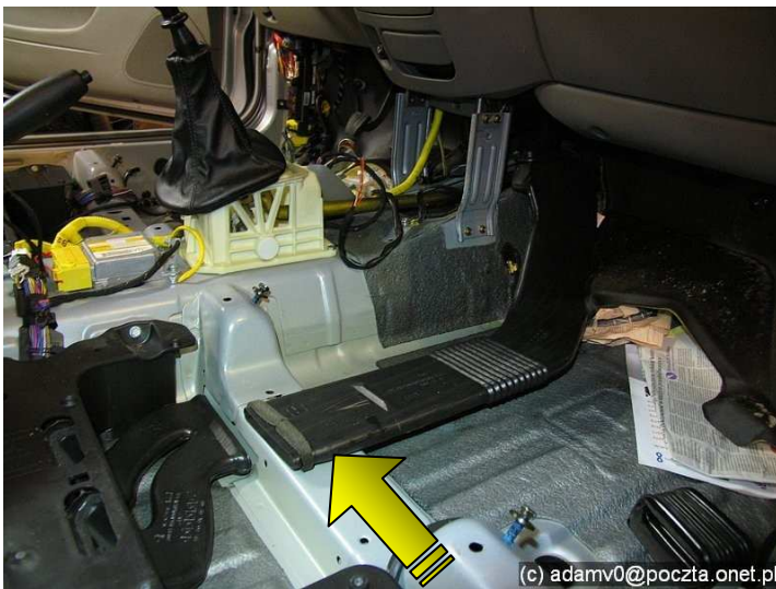
Rozpinamy złącze w metalowym profilu
