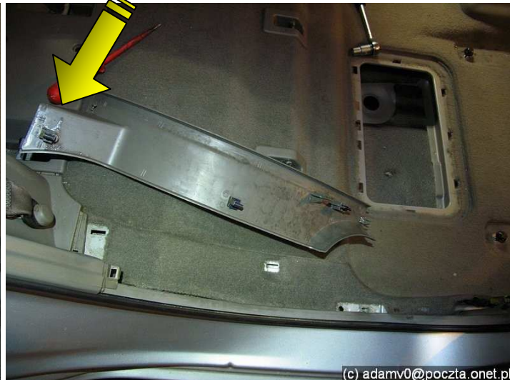
Najgorszy w moim przypadku był tylny zatrząsk, urwałem go. Na zdjęciu po sklejeniu. Z drugiej strony poszło lepiej, ale nie bez nerwów.
