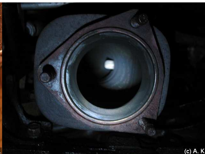
Kołnierz na katalizatorze i biała sonda lambda
